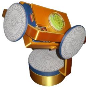
Slika 14. Uređaj napravljen za fizičko mjerenje kuta žiroskopa (Autor slike: Arsen Ivanišević)
